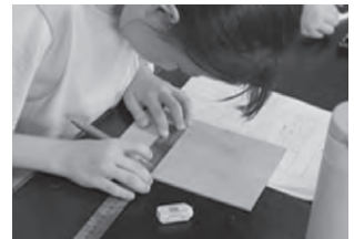
學生先依照機械獸的工作圖，在密集板上繪製各部件
